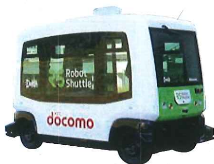
大学構内で試験走行中の「自動運転バス」は、歩行者の存在をスマホからバスに通知して安全に走る(写真提供:九州大学)
